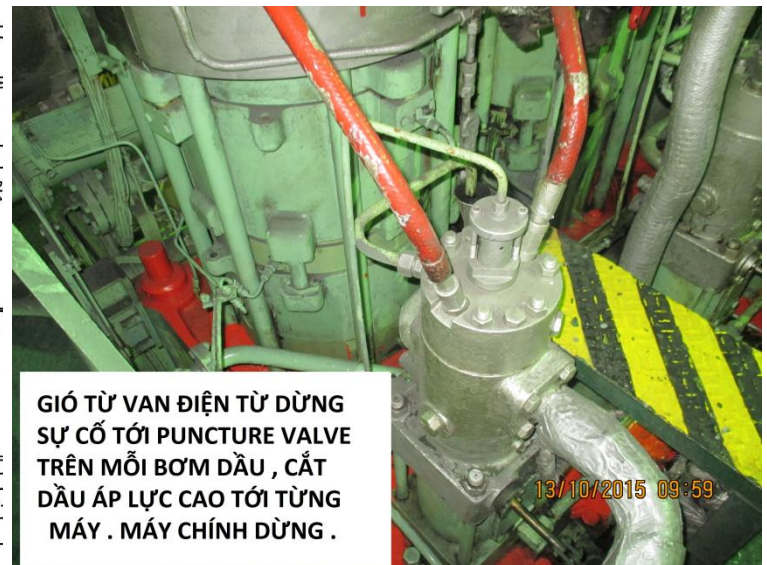
3.6.3 Cấp gió cho puncture valve trên mỗi bơm cao áp , ngắt đường dầu cao áp để dừng máy .
